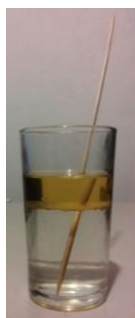
Imagen 13. Refracción de la luz que refleja un objeto, debido al agua y al aceite.
