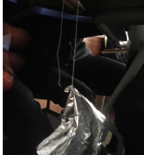
Imagen 15. Bolsa atada a una de las cuerdas, la cual era sometida al peso de las unidades de medida (bolsas o tapas de arena) introducidas en la bolsa.
