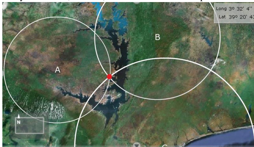
Ilustración 9, simulador de triangulación, e-ducativacatedu., triangulación de tres estaciones de: A, 37 Km; B, 44Km y C, 64Km
