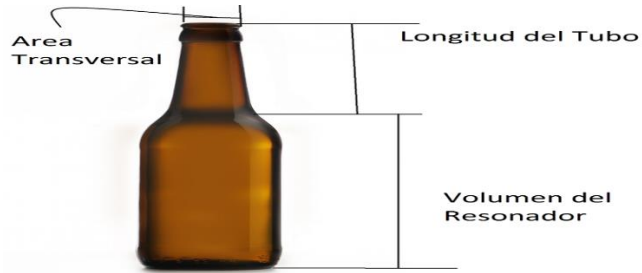
Figura 3. Partes de un resonador (Cocinista, 2017)
