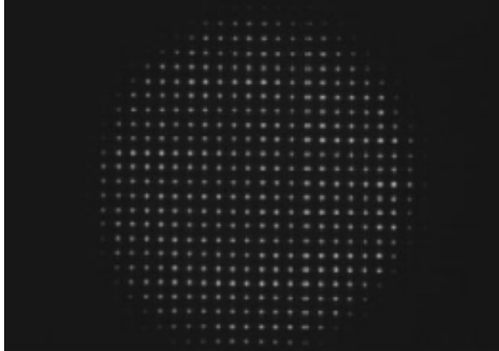
Figura 3.11: la organización exacta de los spots lumínicos con relación a un frente de onda plano el cual está libre de aberraciones[ Tomás, 2014 ]
