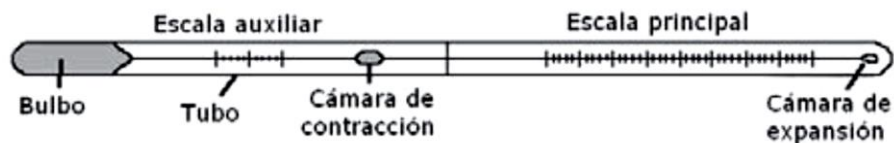
Figura No. 13 Termómetro de vidrio, tomada de (Instrumentación Industrial, 2010, p. 236)
