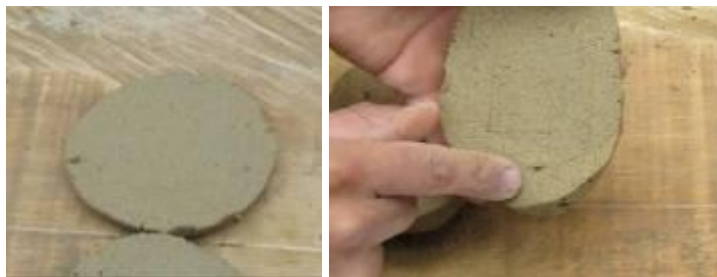
Figura 42: Prueba de la masa, Izq.: masa lista para modelar. Der.: Masa con burbujas
