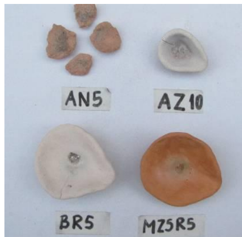
Figura 55: Crisoles después de la fundición de la liga Pandora
