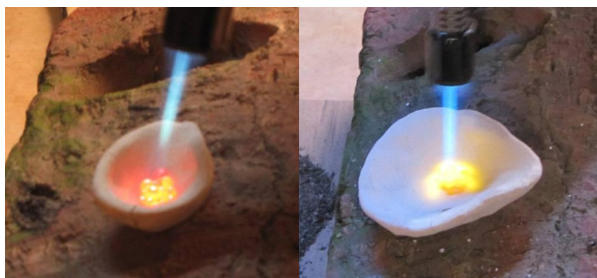
Figura 53: Experimento fundición liga Pandora. Materiales: arcilla amarilla Cuarzo AZ10 (izq). Arcilla blanca-arena BR5 (der)
