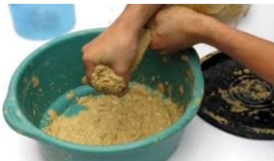
Figura 37: escurrido y limpieza arcilla amarilla
