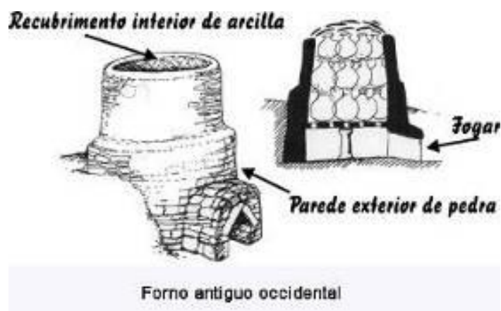
Figura 11: Horno colmena. (Diseño de hornos, 2017. fig. 1.)
