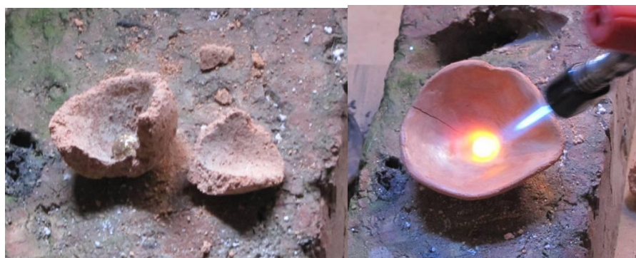
Figura 54: Experimento fundición liga Pandora. Materiales: arcilla amarilla – chamote AH10 (izq) Arcilla marrón-arena-cuarzo MR5Z5 (der)
