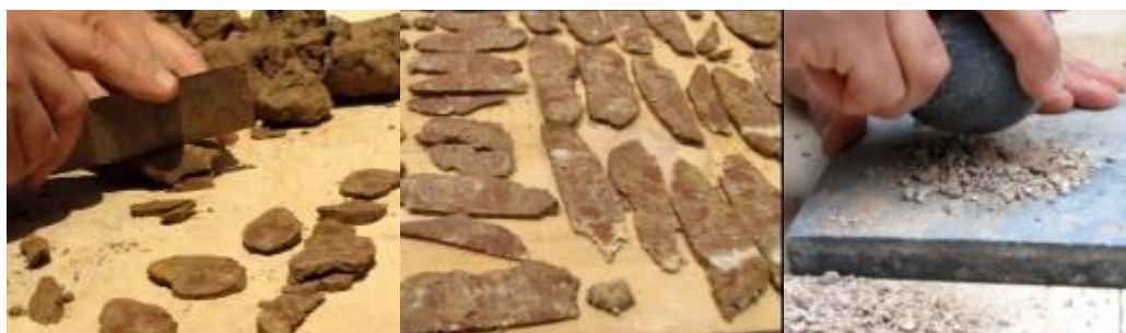
Figura 39: Proceso arcilla marrón: corte en trozos pequeños (izquierda), secado al sol (centro) y trituración (derecha).
