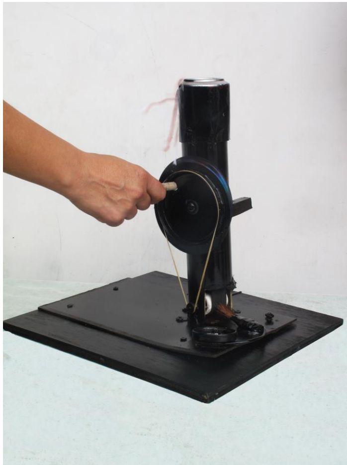
Ilustración 1, Generador de van de Graff construido con materiales a bajo costo por el autor del documento, en vez de motor se diseñó una biela. (Construido por el autor)
