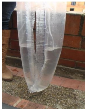
Manguera de polietileno de 4" de diámetro, doblada en U
