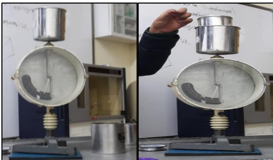
Ilustración 11. La electrificación total de la superficie exterior del recipiente es igual y opuesta a la del objeto.
