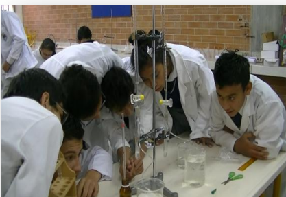
Fotografía 1. Determinación de volumen de hidrogeno en una reacción de sustitución
