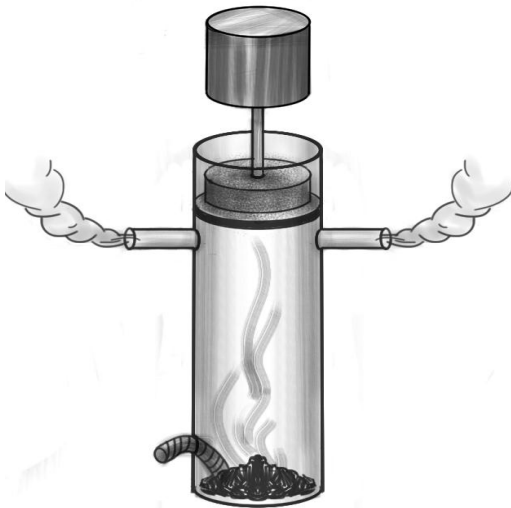
figura 2-3: Motor de embolo diseñado por Christian Huygens (Imagen: tomada de (Moreno Gomez, Gomez Diaz, & Refolio Refolio, 2014, pág. 21))
