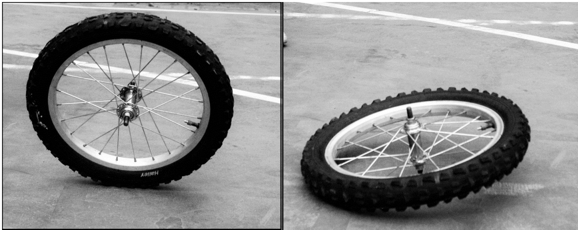
Figura 2.2. Equilibrio de una rueda de bicicleta cuando no se encuentra en movimiento. En el primer diagrama se pone sobre el suelo; en el segundo diagrama se ve cuando cae súbitamente al suelo.
