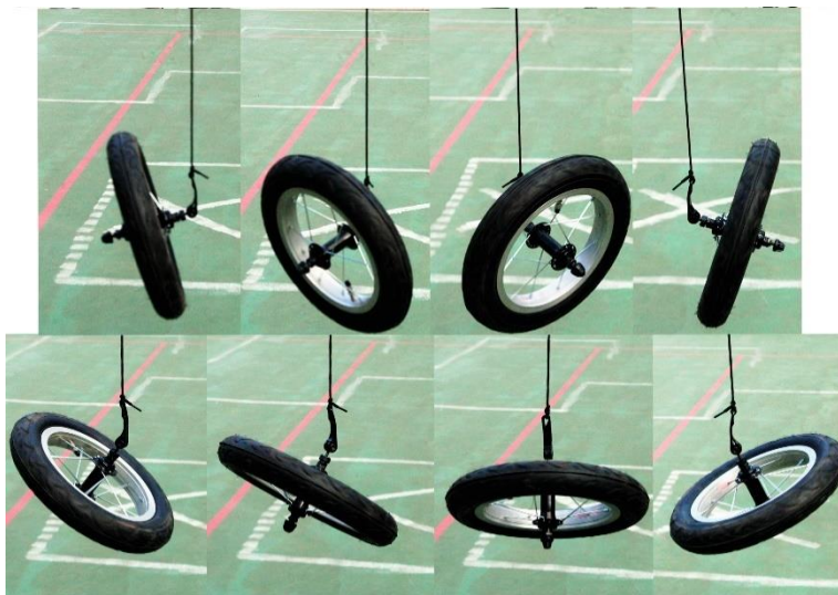
Figura 2.5 descripción del comportamiento de una rueda de bicicleta cuando está rotando en varios instantes y es sostenida por un extremo de su eje solamente por cuerda.
