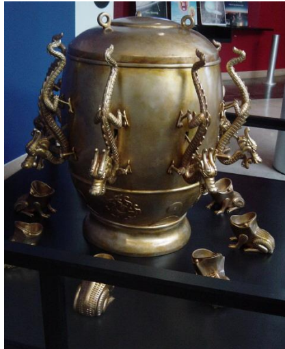
Figura 22: El sismógrafo Chan-Heng es el primer sismógrafo conocido, se construyó en China alrededor del año 130 d.C. Tomado de: http://www.lpi.tel.uva.es/~nacho/docencia/ing_ond_1/trabajos_06_07/io3/public_html/Sismografo/Sismografo.html
