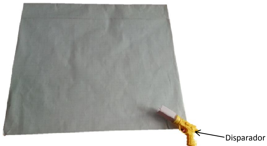
Figura 4. El dispositivo experimental es un plano inclinado a 23 grados en donde se lanza la esfera mediante un cañón y los estudiantes tendrán que variar el ángulo del cañón para lanzar la esfera.
