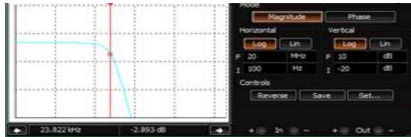
Figura 36. Diagrama de Bode del Filtro de salida
