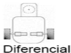
Figura 1. Locomoción Diferencial; Configuración cinemática del robot móvil.
