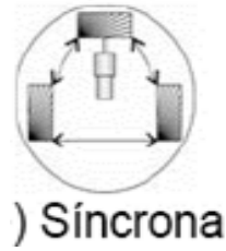
Figura 2. Locomoción Síncrona; Configuración cinemática del robot móvil.
