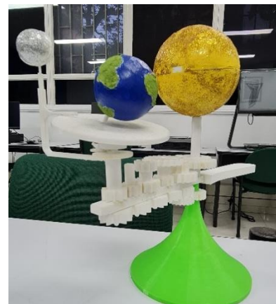
Ilustración 17. Modelo mecánico con engranajes para realizar la actividad de Fases Lunares.
