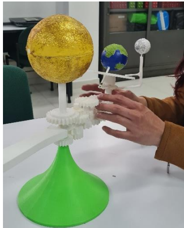
Ilustración 16. Modelo mecánico de engranajes para realizar la actividad de movimientos.
