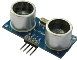
Figura 6. Sensor Ultrasonido (Tomado de http://www.kurtsik.org/blog/?p=1212 )
