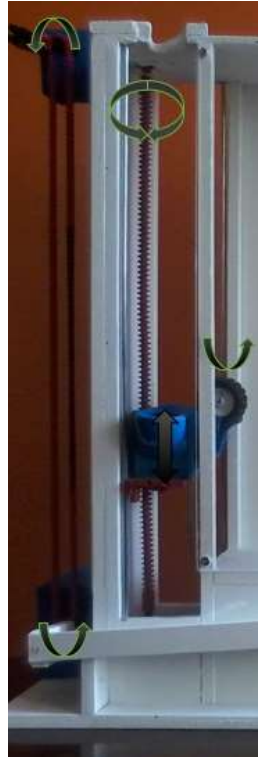
Figura 10. Dirección de movimiento de los sistemas que posee la estructura de experimentación.
