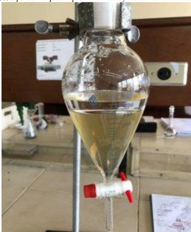
Imagen 9. Separación líquido-líquido con hexano y extracto de aceites esenciales.
