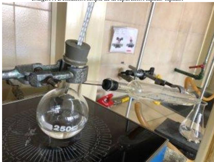
Imagen 7. Destilación simple de la separación líquido-líquido.
