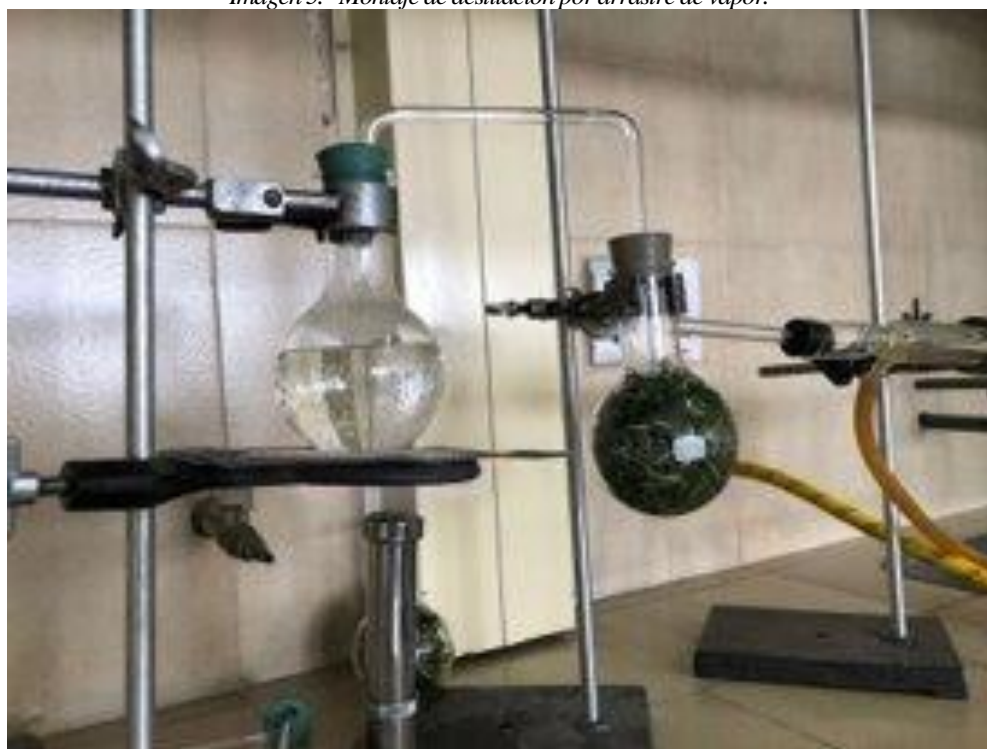
Imagen 5. Montaje de destilación por arrastre de vapor.
