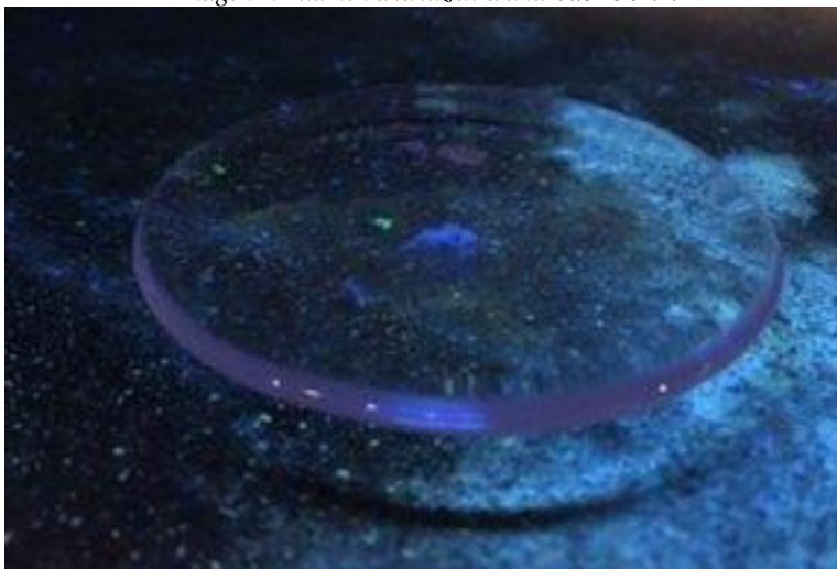
Imagen 2. Examen a la luz uv a una \lambda de 254 nm
