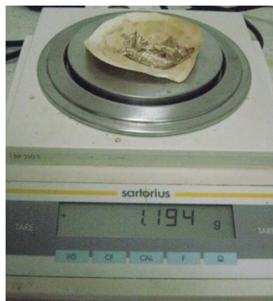
Figura 21: Proceso de pesado de la biomasa del hongo en la Balanza Sartorius
