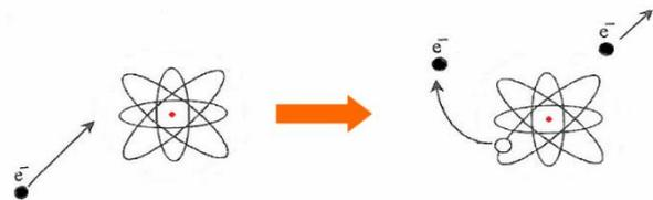
Imagen 11. Proceso de ionización de un átomo de gas.
