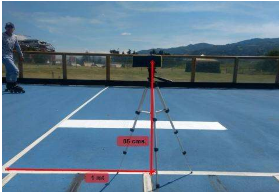
Figura 2. Ubicación del trípode y teléfono celular. Fuente de elaboración propia.
