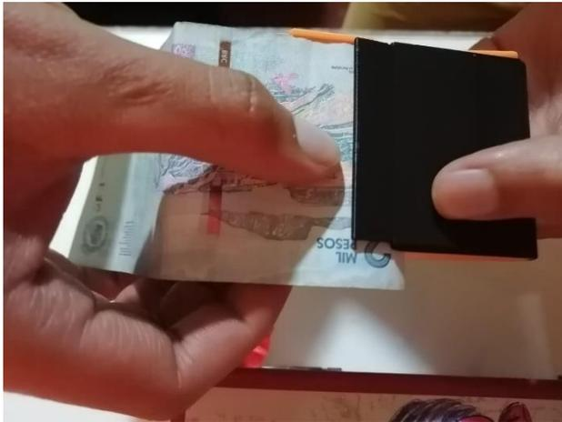
3. En la figura 27 se muestra la ubicación del botón de encendido (interruptor) que se encuentra al costado derecho del dispositivo. Está acompañado de señalética en braille para el fácil reconocimiento por parte de los usuarios invidentes. Este se debe encender sin mover el billete como se indicó en el paso anterior.
