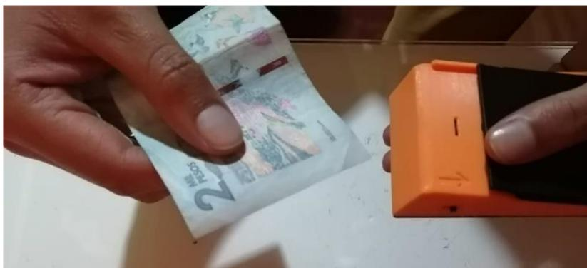
2. Posicionar el billete, y deslizarlo por la parte posterior hasta el tope y mantenerlo estático como se muestra en la figura 26.
