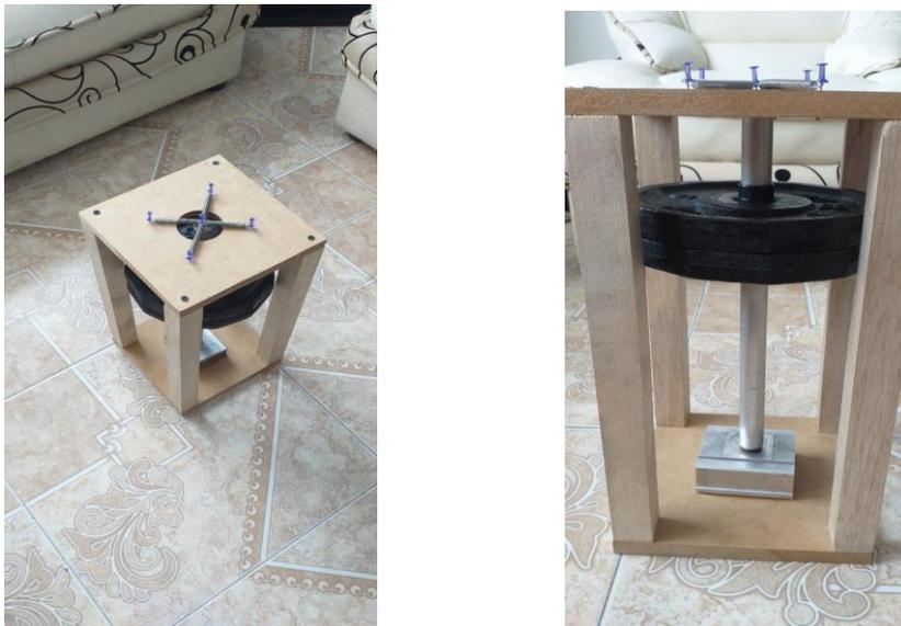
Imagen 32. Estructura del péndulo invertido amortiguado con resortes
