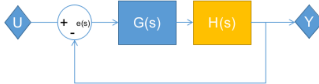
Figura 3.2: Representación en bloques en lazo cerrado de un sistema H(s) con un controlador G(s)
