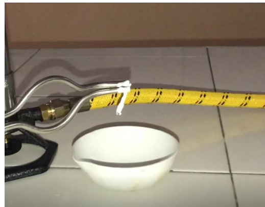
Imagen 3. Combustión de la cinta de Magnesio, formación del óxido e hidróxido de magnesio. Fuente: propia
