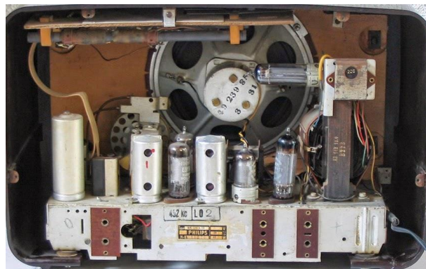
Ilustración 92. Interior del Radio Philips BX321A.
