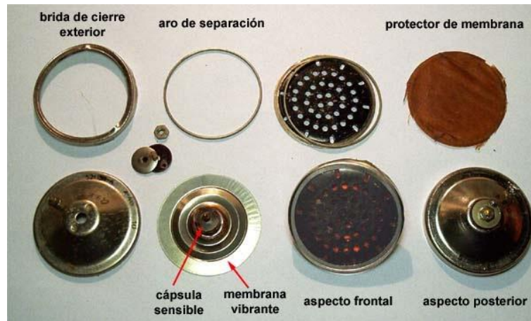
Ilustración 68. Partes de un micrófono de carbón.
