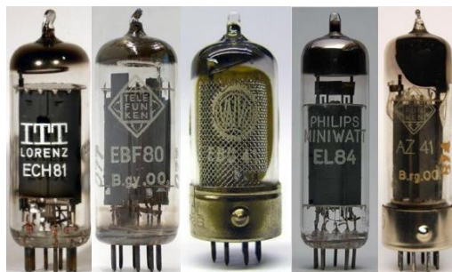
Ilustración 93. Válvulas ECH81, EBF80, EBC41, EL84 y AZ41.
