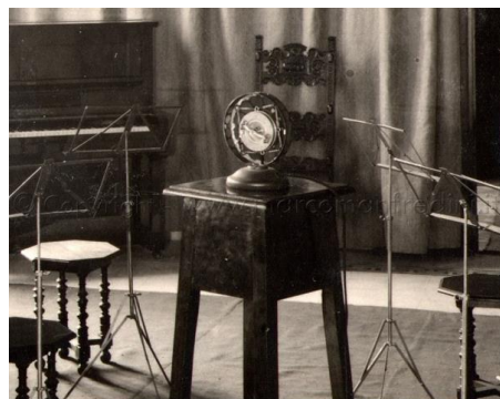
Ilustración 8. Micrófono de la estación de radio en Milán fabricado por Western Electric mod. 387 carbón.
