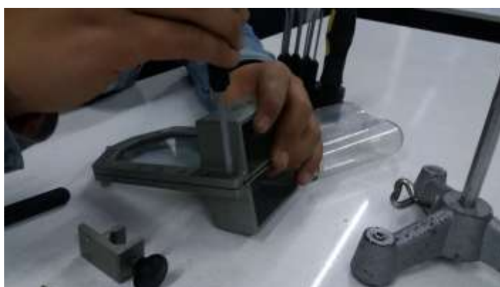
Imagen 33. Fotografía de la limpieza del aparato de hilos de agua.
