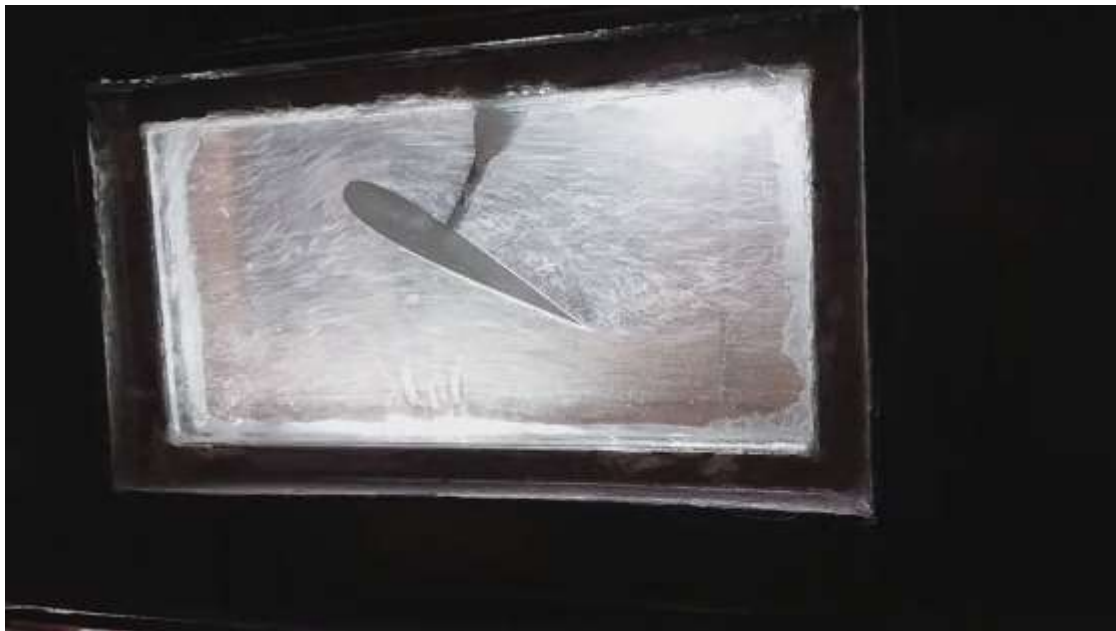
Imagen 68. Fotografía de la visualización de las líneas de flujo turbulentos dentro del canal de corrientes.
