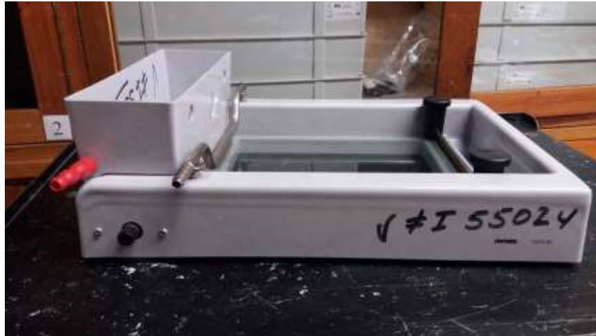
Ilustración 17 Fotografía de la cubeta de líneas de flujo.
