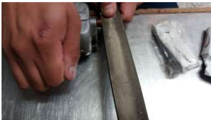
Imagen 51. Fotografía del Proceso de lijado del eje del motor.
