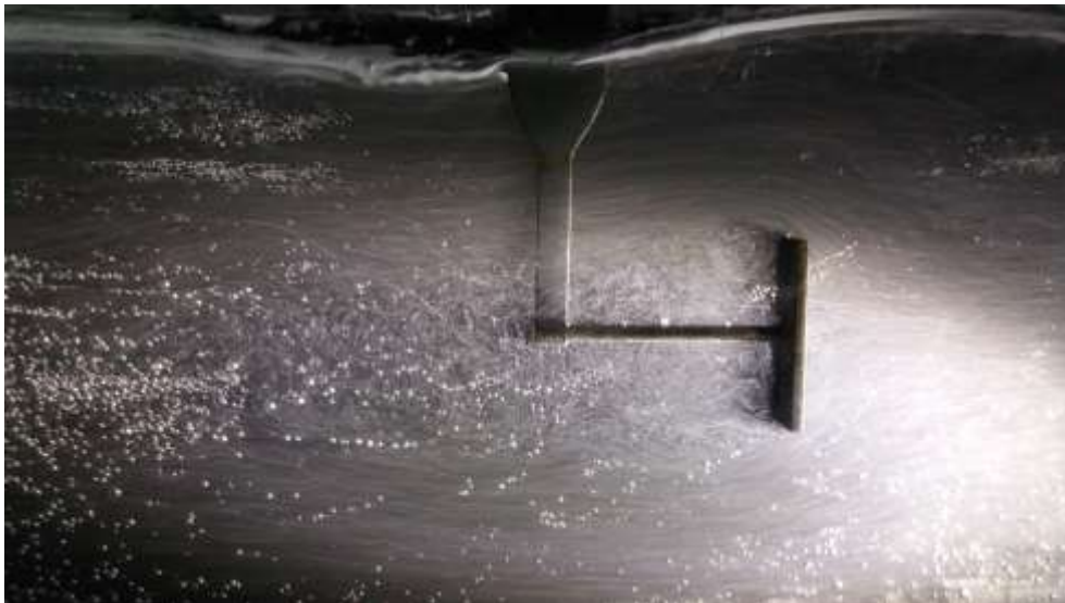
Imagen 70. Fotografía de la visualización de las líneas de flujo al interactuar con un accesorio del montaje.
