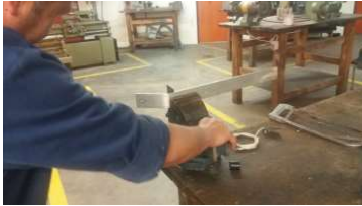
Imagen 63. Fotografía de la Formación de la L de aluminio.
