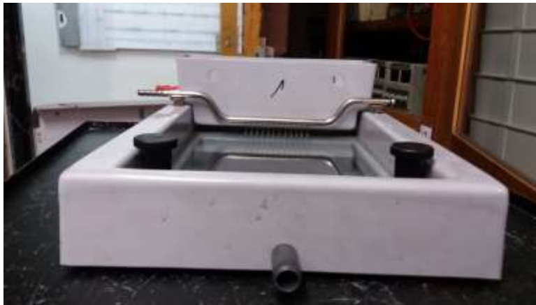
Imagen 22. Fotografía cubeto de líneas de flujo.
