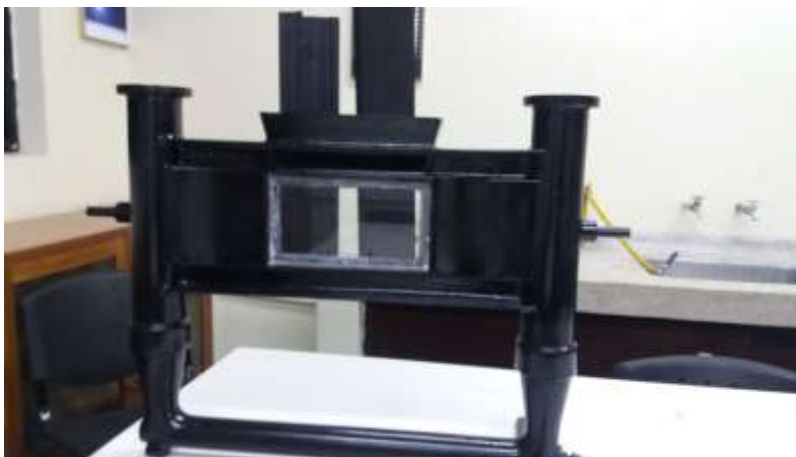
Imagen 453. Fotografía del pegado de los vidrios por primera vez.
