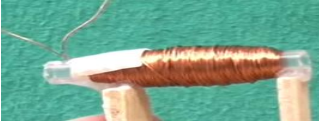
Ilustración 40. Bobina motor solenoide (Fuente: Elaboración propia)
