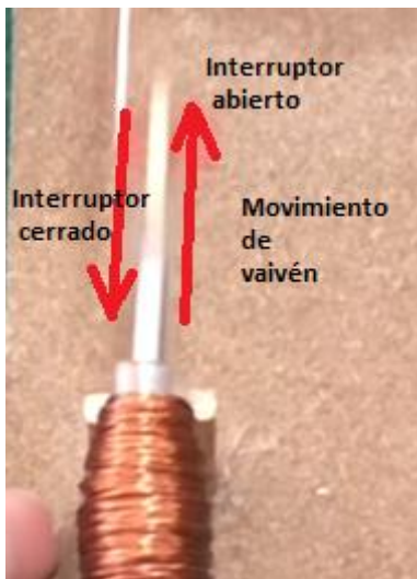
Ilustración 46. Dirección de desplazamiento de barra de hierro debido a la interacción con el campo magnético generado al interior de la bobina (Fuente: Elaboración propia)
