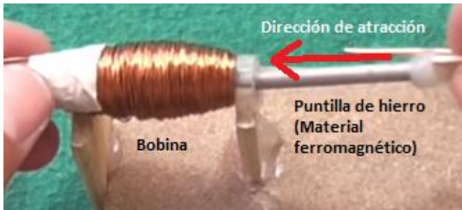
Ilustración 45. Sistema de atracción bobina – barra de hierro (Fuente: Elaboración propia)
