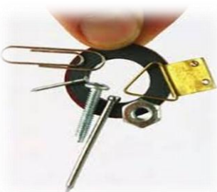
Ilustración 69. Cuerpos ferromagnéticos atraídos por un imán (Fuente: Elaboración propia)
