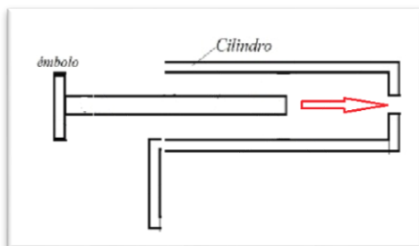
Ilustración 9. Ensamble embolo – pistón (Fuente: Elaboración Propia)
