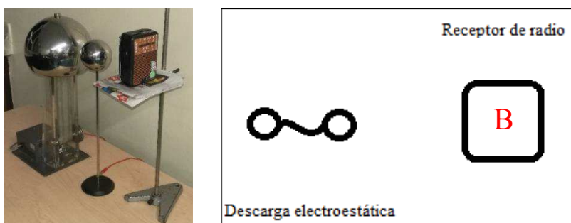
Imagen 21. Receptor de radio ubicado en dirección perpendicular a la descarga y la posición de la antena en la forma B.
