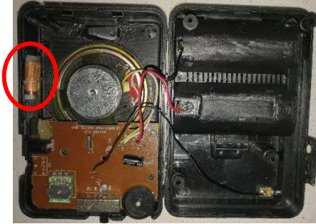
Imagen 13. Ubicación de la antena de las frecuencias AM y SW encerrada en rojo en el interior del receptor de radio.
