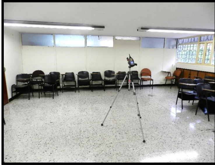
Figura 15. El sonómetro SVAN – 943 colocado con un trípode fijo en la zona central del recinto receptor, para evaluar el ruido de fondo.
