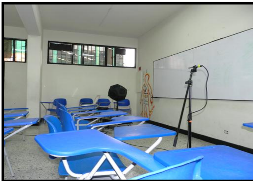
Figura 14. Ubicación de la fuente y micrófonos omnidireccionales para medir el tiempo de reverberación de cada una de las salas emisoras (aula C108).
