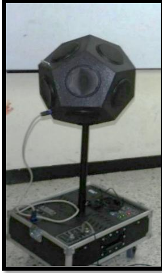
Figura 10. Fuente Omnidireccional de 0. 1 dB OMNI12/AMPLI12 usada para medir las condiciones acústicas de los espacios a evaluar.
