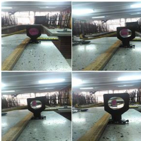
Ilustración 11. Experimento para observar objetos con lentes. Elaboración propia.
