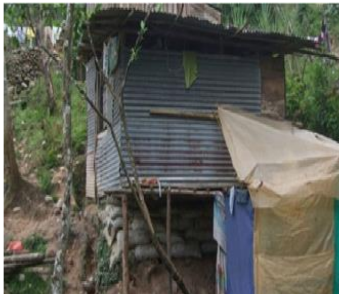
Fotografía 2 Chicangana & Harman, donde se muestra la nivelación del suelo por medio de costales.
