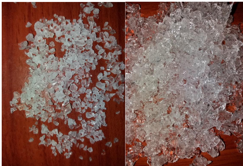
Figura 2. Hidrogel en estado seco (Izquierda) e hinchado (Derecha)
