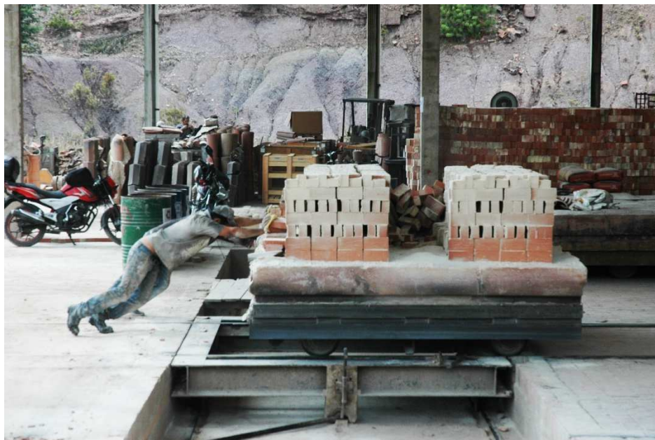
Imagen 72. Ubicación de la vagoneta sobre los rieles en donde movilizan la vagoneta para retirar el producto, limpiar la vagoneta. 2017.
