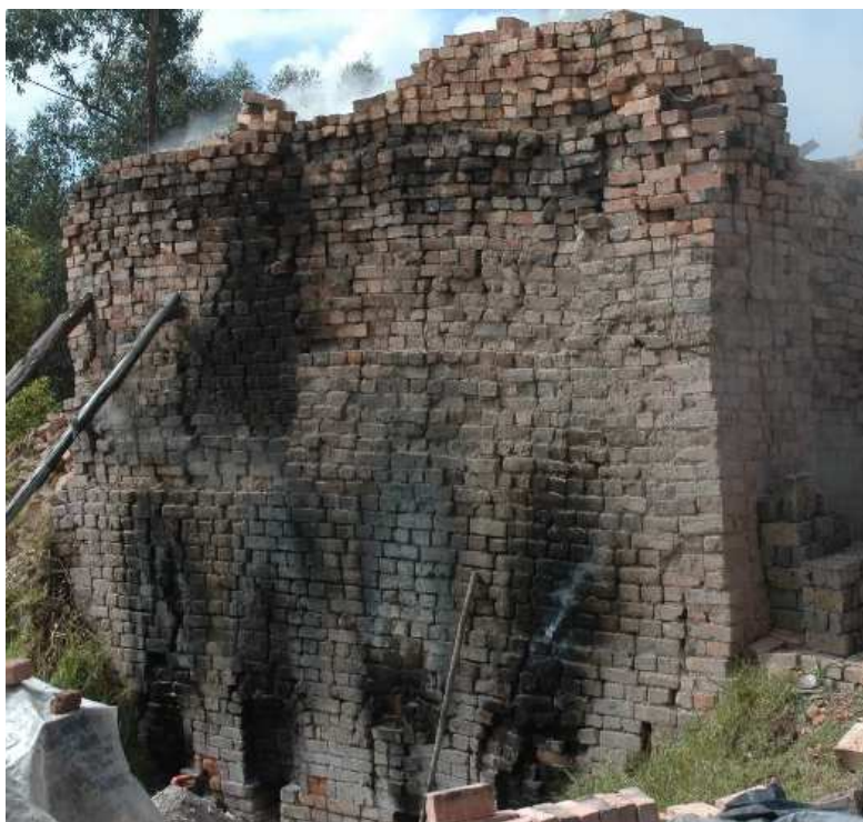
Imagen 25. Hornillas por donde se le da inicio a la cocción del ladrillo. 2017.
