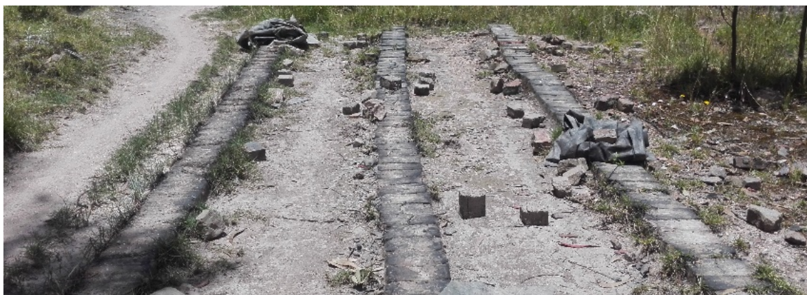
Imagen 21. "Carras" guías en donde se ubican los ladrillos para el secado. 2017.
