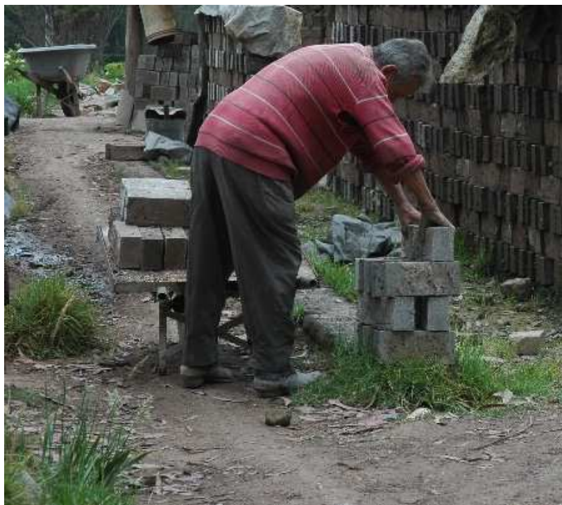
Imagen 24. Transporte del ladrillo desde la zona de secado hasta el horno. 2017.
