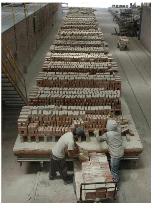
Imagen 72. Ubicación de la vagoneta sobre los rieles en donde movilizan la vagoneta para retirar el producto, limpiar la vagoneta. 2017.
