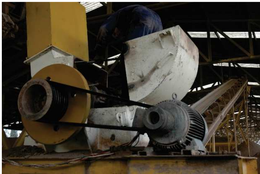
Imagen 37. Desatascos de molino de martillos en trituración. 2017.
