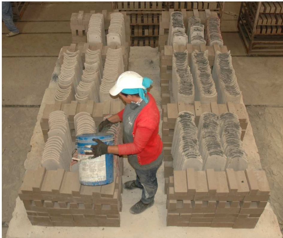
Imagen 82. Aplicación de carbón sobre la teja. 2017.
