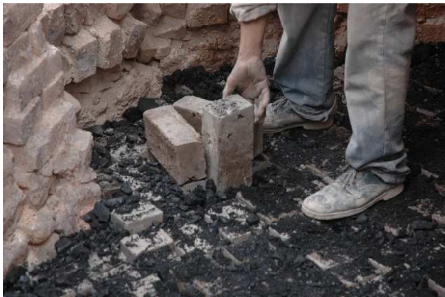
Imagen 29. Buitrones para alimentar el horno. 2017.
