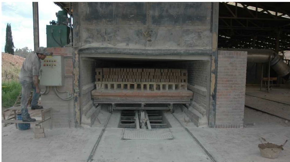
Imagen 84. Impulso de la vagoneta al interior del horno. 2017.
