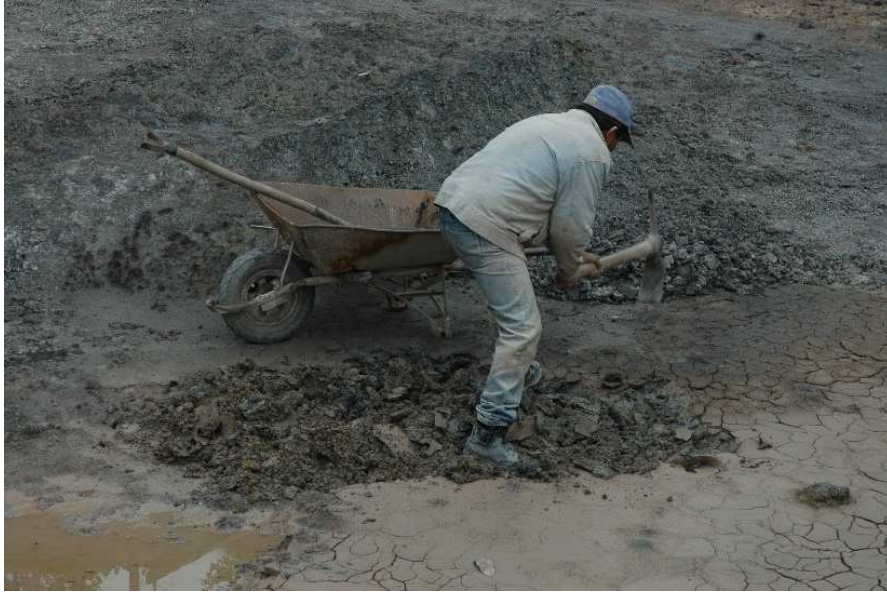
Imagen 10. Picado de la arcilla en la mina. 2017.
