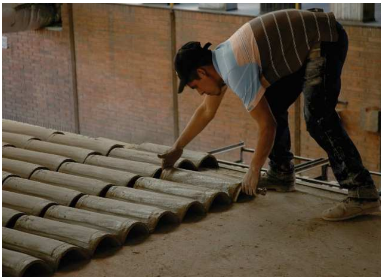
Imagen 48. Ubicación de teja para el secado. 2017.
