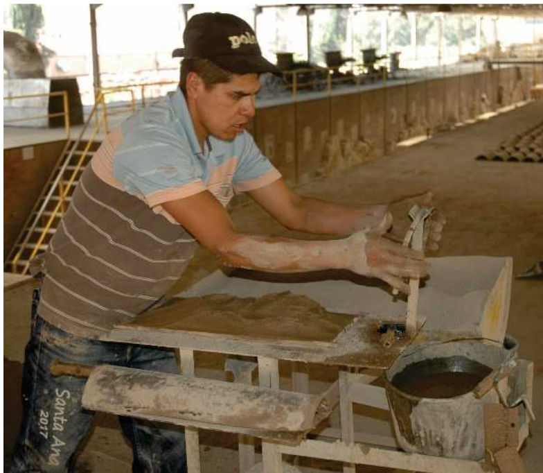
Imagen 45. Retirar excedentes superiores de masa. 2017.
