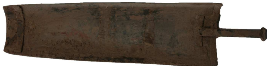
Imagen 91. Molde para teja tipo española, vista interna. 2017.
