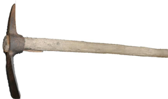
Imagen 16. Pica usada para picar el carbón y la arcilla en la mina. 2017.
