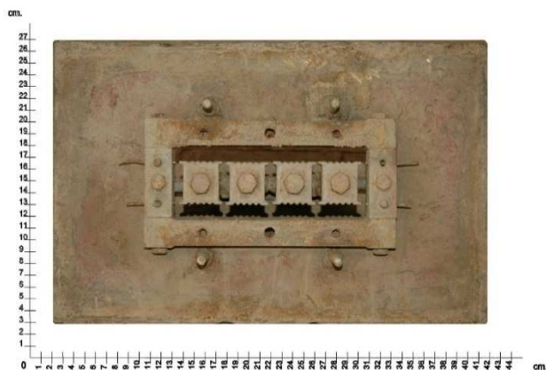
Imagen 54. Molde teja plana y teja plana. 2017.
