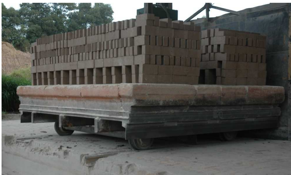
Imagen 83. Vagoneta lista para ingresar al horno. 2017.
