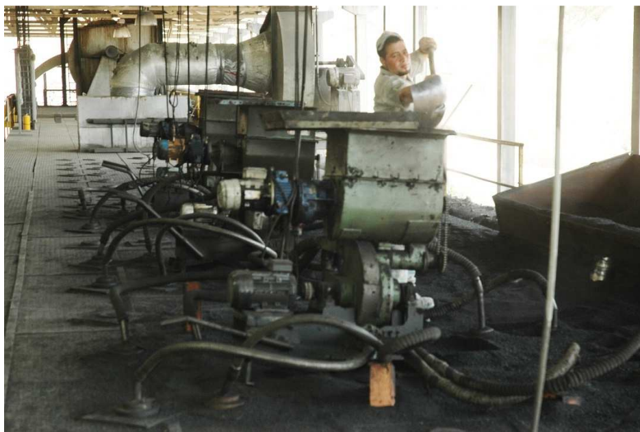
Imagen 69. Suministro de carbón a los Carbojet. 2017.
