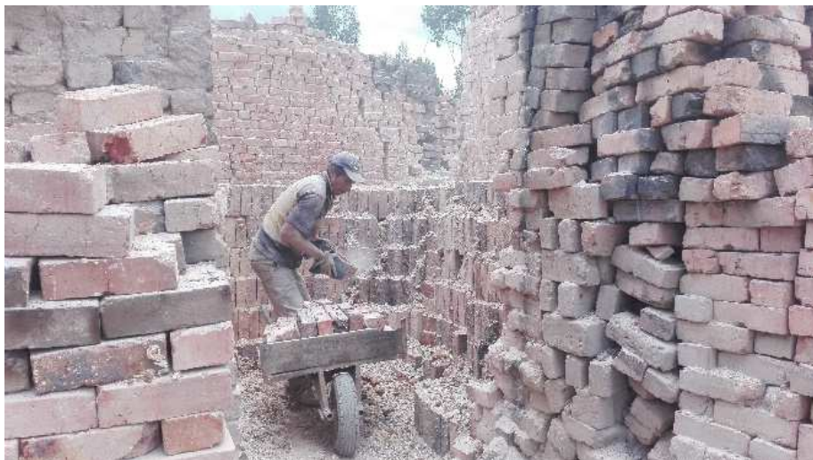
Imagen 27. Extracción de ladrillo cocido. 2017.
