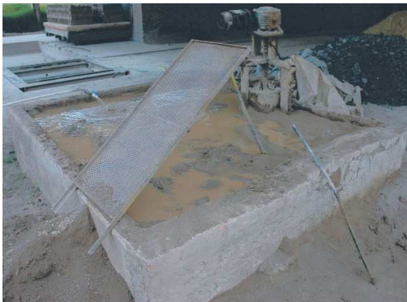
Imagen 41. Preparación de la arcilla. 2017.
