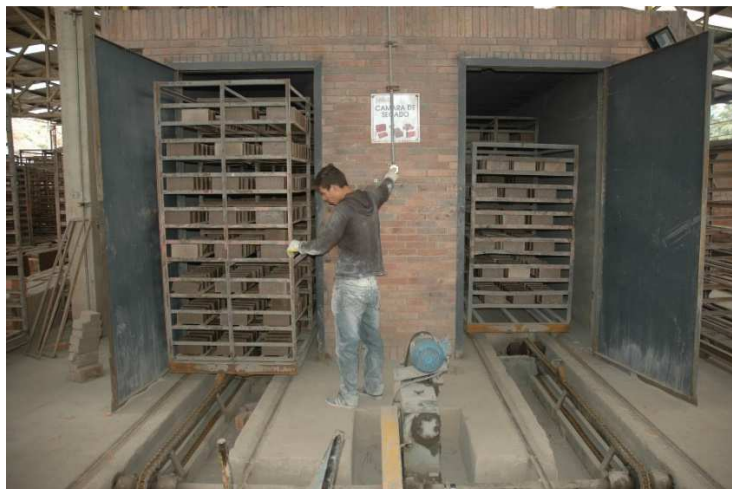
Imagen 67. Impulso de los estantes al interior del secador. 2017.
