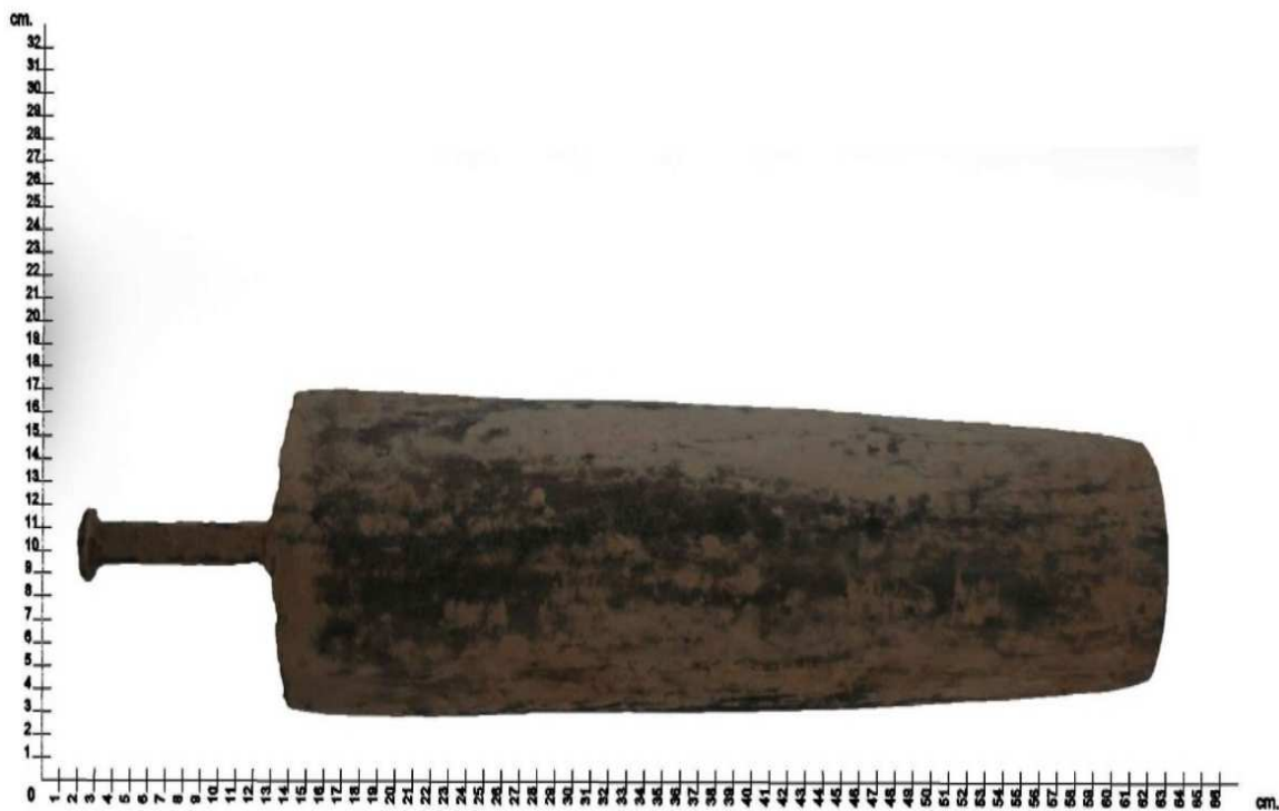
Imagen 92. Molde para teja tipo española, vista superior. 2017.
